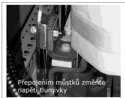
Obr. 5-6. Způsob připojení tlumivek u velikostí FR13/14
